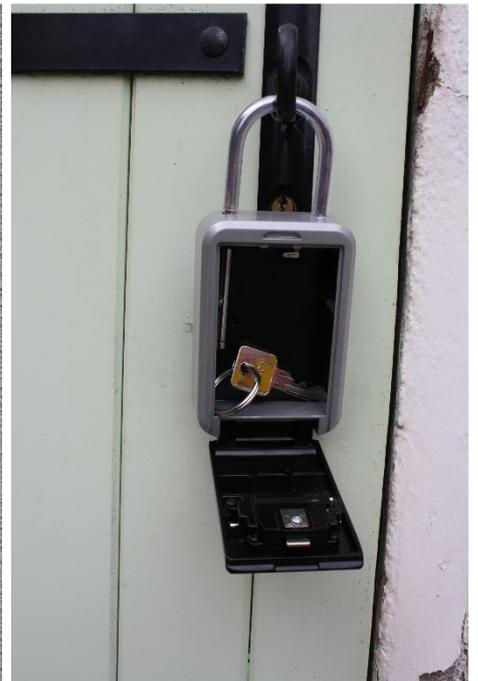
Pour décrocher la boîte à clé, il y a un petit loquet de déverrouillage à l'intérieur.
